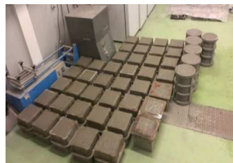
Rys. 2. Przykładowa seria próbek betonowych wykonanych w laboratorium
