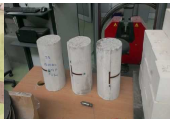
Rys. 3. Probki walcowe z naklejonymi tensometrami
