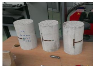
Próbki walcowe z naklejonymi tensometrami
